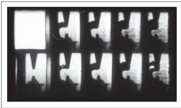
Abbildung 7: Hochgeschwindigkeitsaufnahme einer irregulären Funkenentladung (Bildfolgefrequenz 2 \times 10^5 Bilder pro Sekunde). Man erkennt die Ausbreitung einer gebogenen, schlauchförmigen Plasmablase. Die Ursache dafür ist ein Funke, der nicht den direkten Weg zwischen den Elektrodenenden nimmt, sondern seitlich an den Elektroden ansetzt. Wegen der Abweichung von der sphärischen Geometrie ist eine präzise Fokussierung durch ein Rotationsellipsoid nicht mehr gewährleistet.
