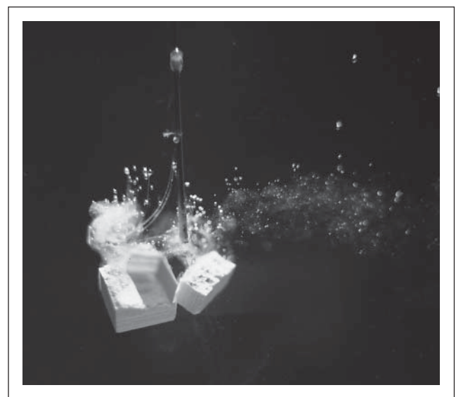
Abbildung 23: Wirkung einer fokussierten Stoßwelle auf einen würfelförmigen Kunststein mit einer Kantenlänge von 10 mm (Stoßwelleneinfall von rechts). Man erkennt den an einem Draht gehaltenen Stein, die Fragmentation in wenige Bruchstücke und Kavitationsblasen im Stoßwelleneinfall.
